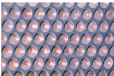
Keramikou zesílený polymerový kompozit obnoví povrch a fakticky zabraňuje budoucí korozi.
