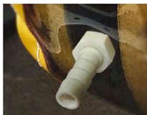
Drenážní nátrubek ze 100 % PTFE, model 1 (vnější průměr 16 mm) pro pryžové hadice
