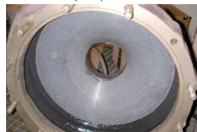
Ztracených 15 % kovu je efektivně nahrazeno vyztuženou keramickou vrstvou, odolávající opotřebení a erozi lépe než originální díl.
