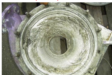
Ztráta 10 až 15 % kovu opotřebením a erozí způsobí nefunkčnost celého dílu.
